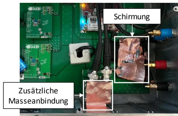
**Bild 8:** Schirmung der möglichen Koppelstrecke und zusätzliche Masseanbindung von Sensor und Injektor
